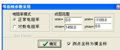
正常电阻率：断面图参数为电阻率的真实值
